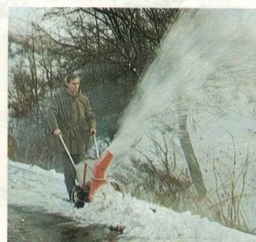
**Schneeräumen und -schleudern.** Schwenkbare, 85 cm breites Räumschild, Schneeschleuder bis zu 10 m Wurfweite und ca. 45 cm Arbeitsbreite und beliebig verstellbare Wurfrichtung.
