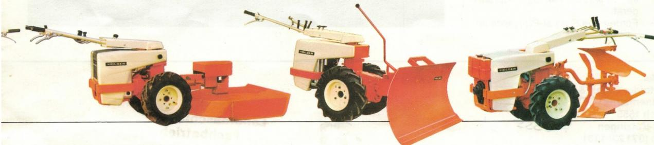
**HOLDER-Mulchgerät** 70 cm Arbeitsbreite mit Mulchmesser zum Mulchen im Obst-, Beeren- und Weinbau. Rebholz- und Gestrüppmesser zum Zerkleinern von Reb- und Schnittholz.
