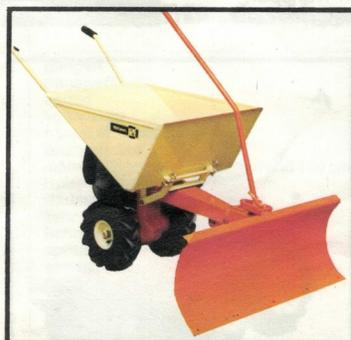
**Transportieren** mit Transportmulde, nach vorn kippbar, Inhalt ca. 70 Liter. Hauptlast ruht auf Antriebsrädern, dadurch gute Bodenhaftung. Vorteilhaft beim Schneeräumen.
